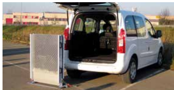
Trittläche aus rutschfestem, genopptem Aluminium
