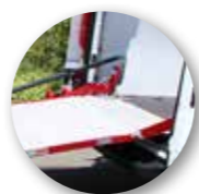
Bewegliche Übergangsklappe zur Ladefläche
