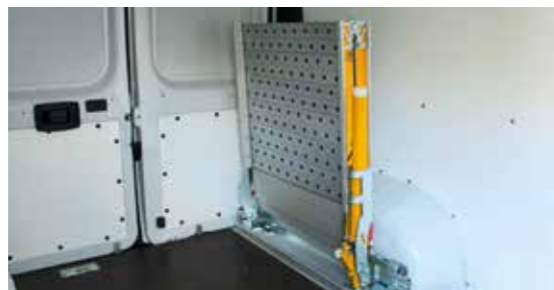
Trittfläche aus rutschfestem, gelochtem aluminium
