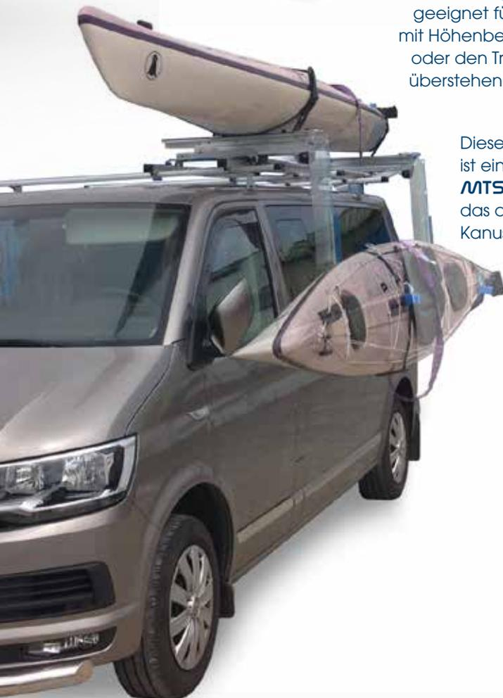
Diese spezielle Anwendung ist eine Abwandlung eines **MTS**-Leiterlifts und erlaubt das alleinige Aufladen eines Kanus auf das Fahrzeugdach.
