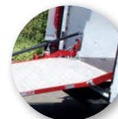
Bewegliche Übergangsklappe zur Ladefläche
