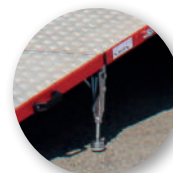
Einstellbare, selbst positionierende Füße
