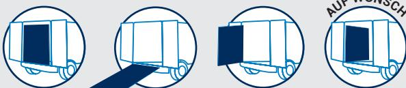
**AUS- UND EINKLAPPEN:** Patentiertes Klapp- und Schwenksystem. Horizontales Aus- und Einklappen zum Laden und Abladen der Transportgüter. Vertikales Schwenken um 90° nach außen für ungehinderten und schnellen Zugang zur Ladefläche ohne Benutzung der Rampe. Das Federsystem gleicht das Gewicht der Rampe aus, so dass sie sicher und ohne Kraftaufwand aus- und eingeklappt werden kann.
